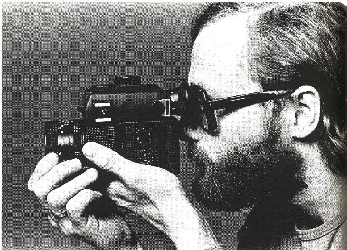
Rolleiflex SL 2000 F er perfekt til stativoptagelser, men kameraet er også godt til håndoptagelser i bredformat. Der er udløserknapper på begge sider af kamerahuset.
